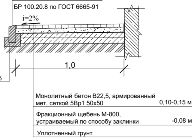
Конструкция тротуарного покрытия из тротуарной плитки. Тип III
